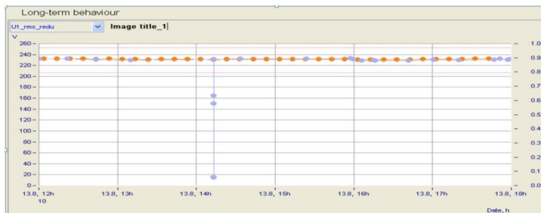
圖 7 電壓紀錄示例(6 h)：供電電壓幅度之 10 min r.m.s 值及包含單相 LV 系統( U_{\text{din}} = 230 \text{ V} )中的電壓變動(1/2 週期 r.m.s 值)之額外紀錄
